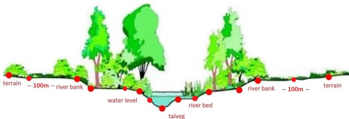
Фиг. 3-3 Характерни точки на заснемане при напречен профил
