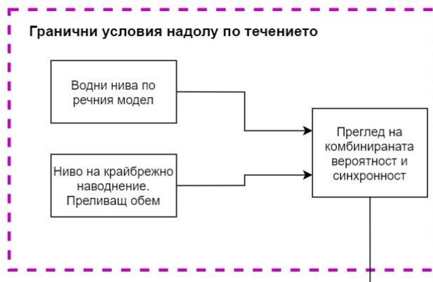
Фиг. 4-14 Схема на стъпките по определяне на долните гранични условия
