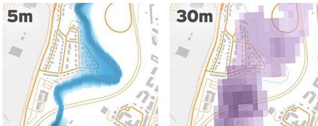
Фигура 4-5 Разлика в резултатите за параметрите на заплахата от модели с резолюции 5 м (ляво) и 30 м (дясно)
