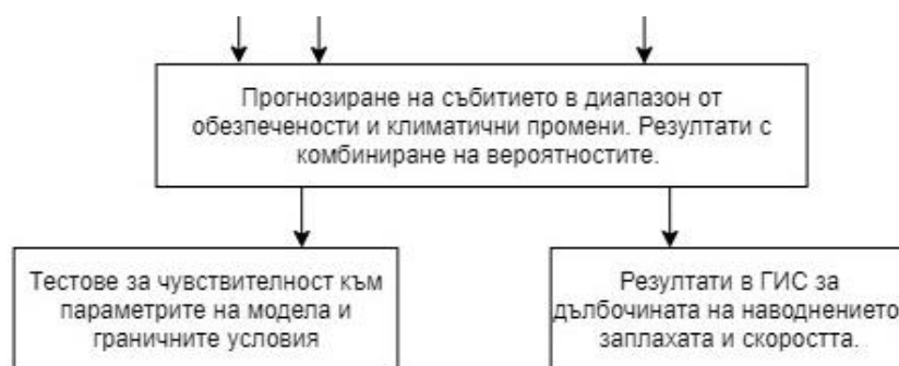
Фиг.6-11 Схема на валидиране и прилагане на хидродинамичния модел
