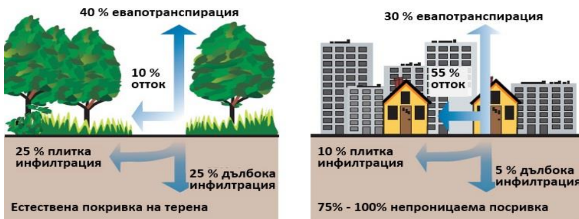
Фиг. 4-10 Различни процеси, които влияят на дъждовните наводнения в неурбанизиран (ляво) и урбанизиран (дясно) райони
