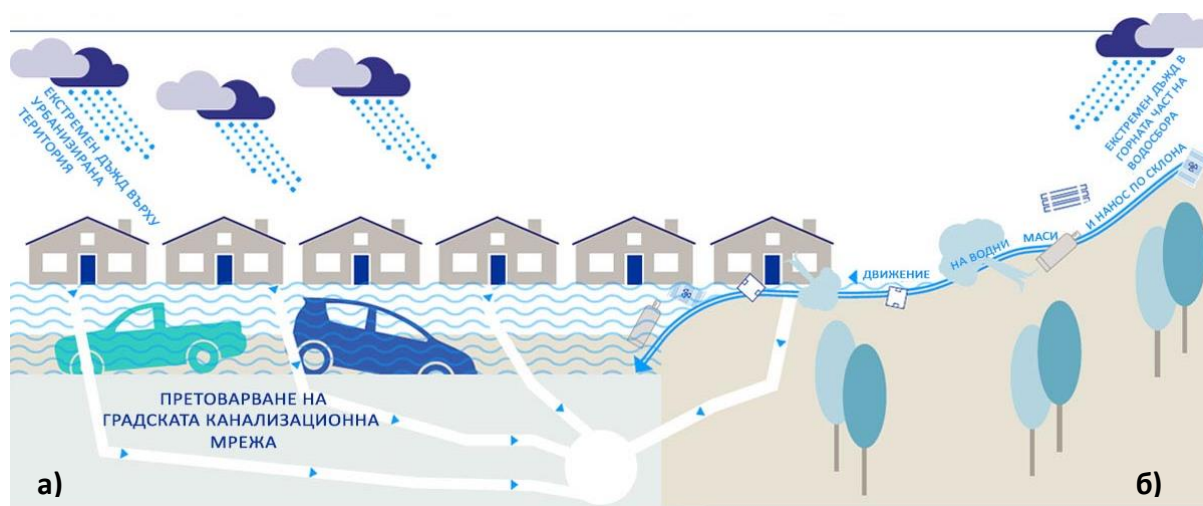
Фиг. 1-3 Примери за дъждовни наводнения: а) Интензивният дъжд насища градската канализационна система, б) Стичаща се дъждовна вода, падаща върху по-висок терен, напр. склонове, които не могат да поемат водата (източник: Zurich.com)
