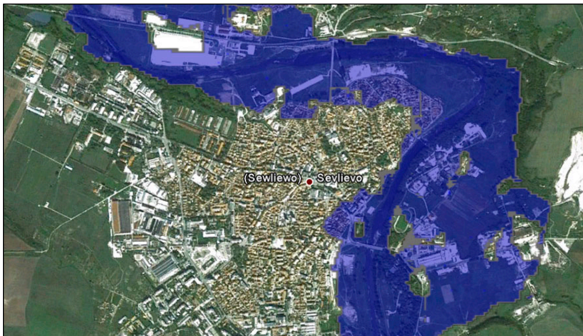
фигура В.17: 2D-изчислителна мрежа на базата на свързване на височинните точки от SRTM-височинен модел на терена (подложка: Google Earth)
