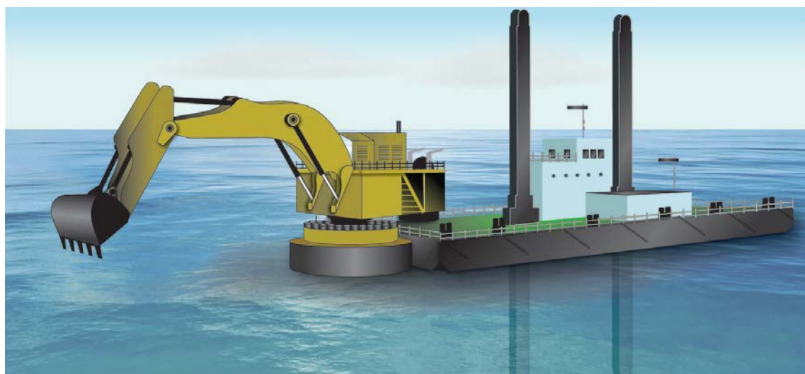
Фигура 4.8: Схема на драга с обратна лопата
