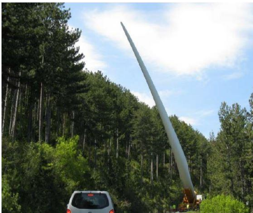
Фигура 12: Транспортиране на остриета с помощта на превозно средство "подемник на остриета".
