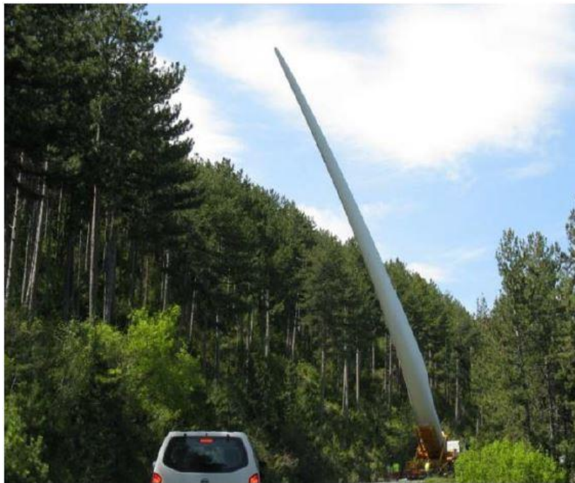
Εικόνα 2-12: Μεταφορά πτερυγίων με χρήση οχήματος «bladelifter».
