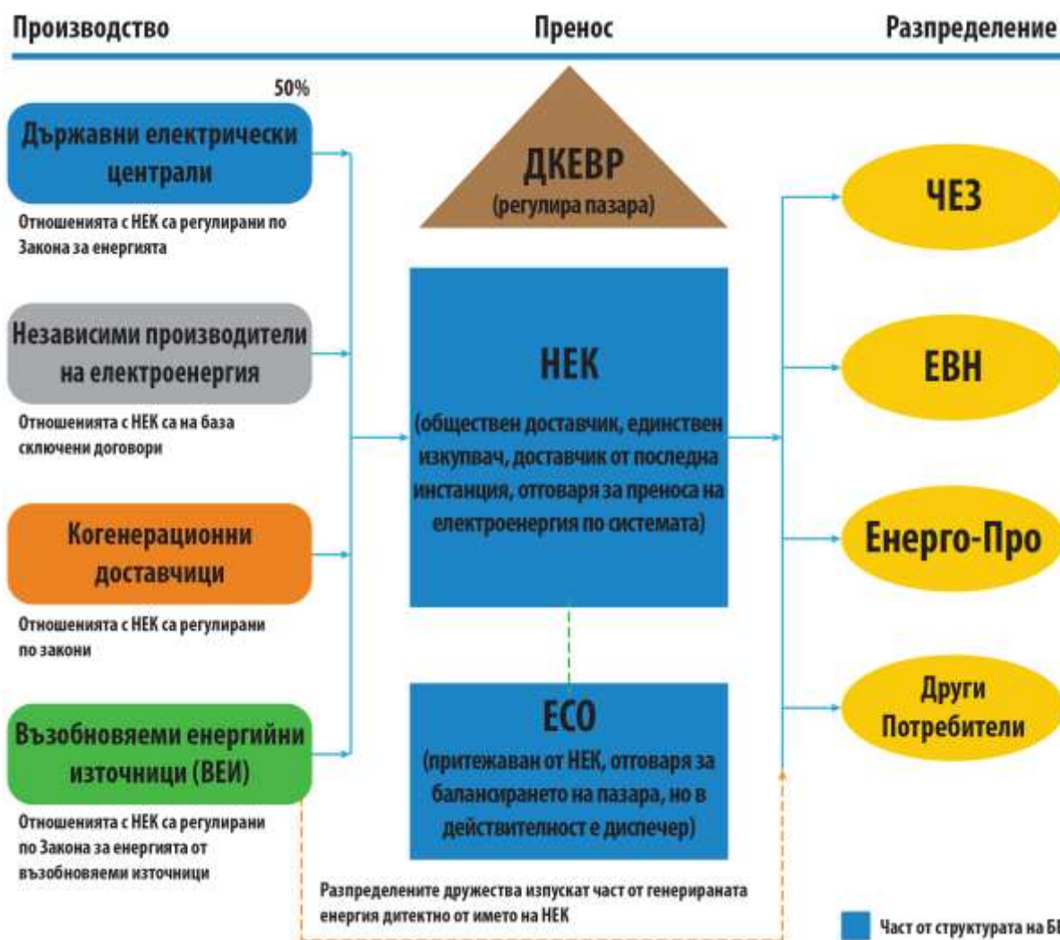
Фигура 10: Схема на регулирания електроенергиен пазар на Република България
