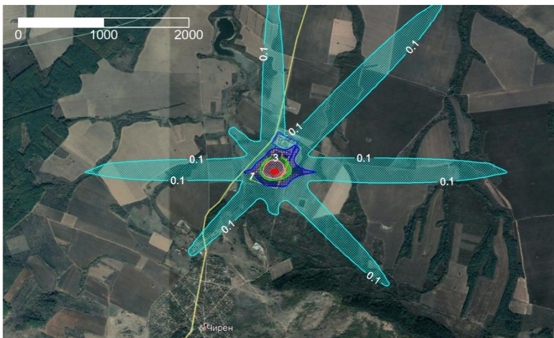
Фигура 21 Средногодишно замърсяване (в µg/m 3 ) с азотни оксиди (NO x ) за 250 дни от строителна техника
