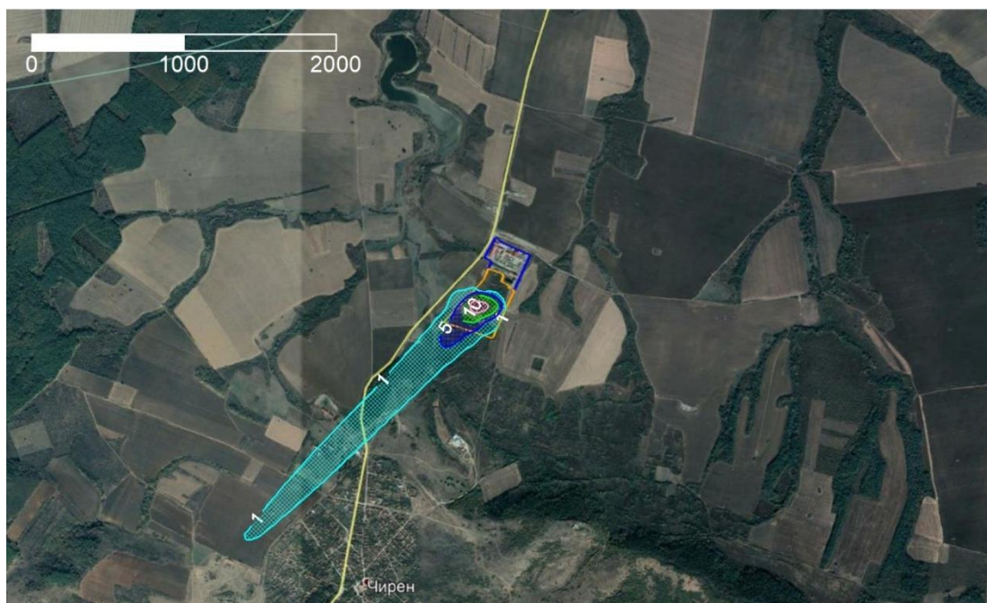
Фигура 20 Максимално еднократно замърсяване (в \mu\text{g}/\text{m}^3 ) с \text{ФПЧ}_{10} от прахов площен източник
