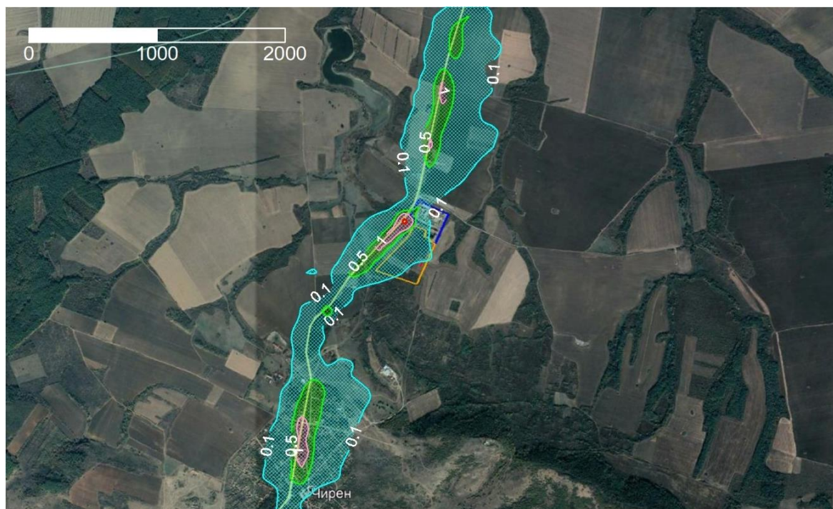
Фигура 23 Средногодишно замърсяване с азотни оксиди (NOx) от път VRC1036 по време на строителството
