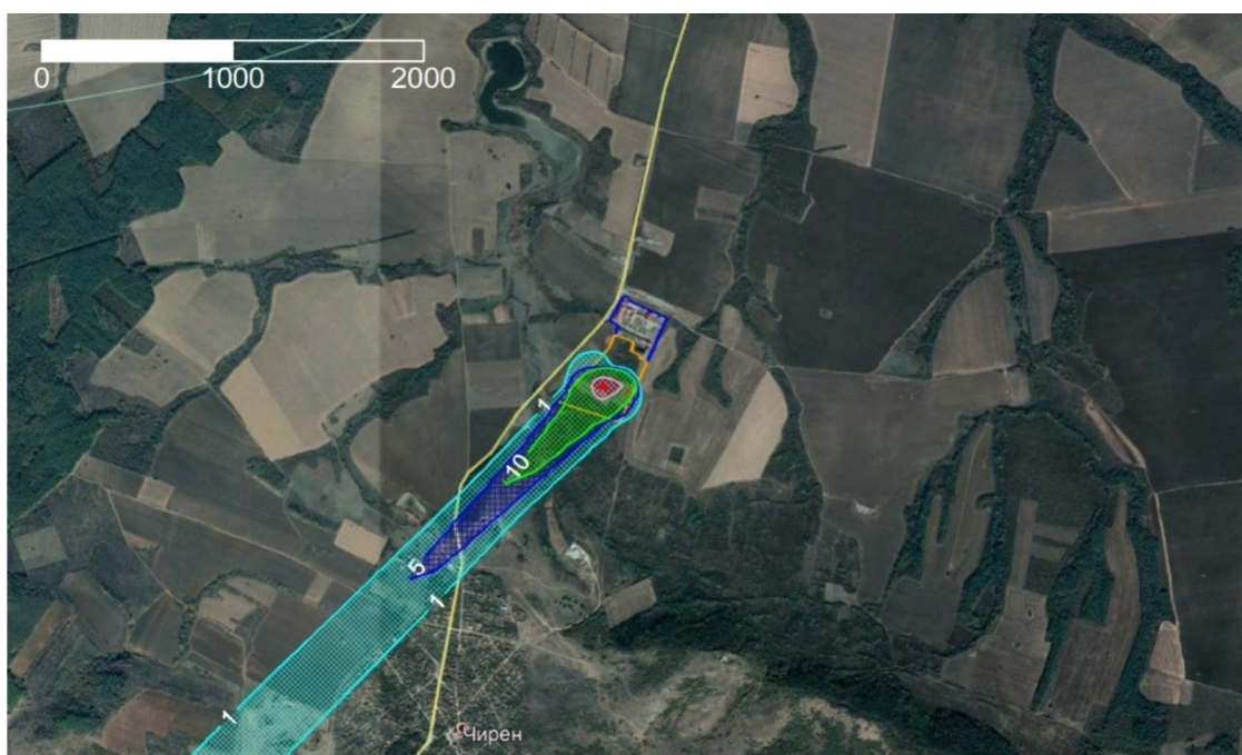
Фигура 22 Най-неблагоприятните метеорологични условия са североизточен вятър (45°) със скорост 2.5 m/s и клас на устойчивост Е
