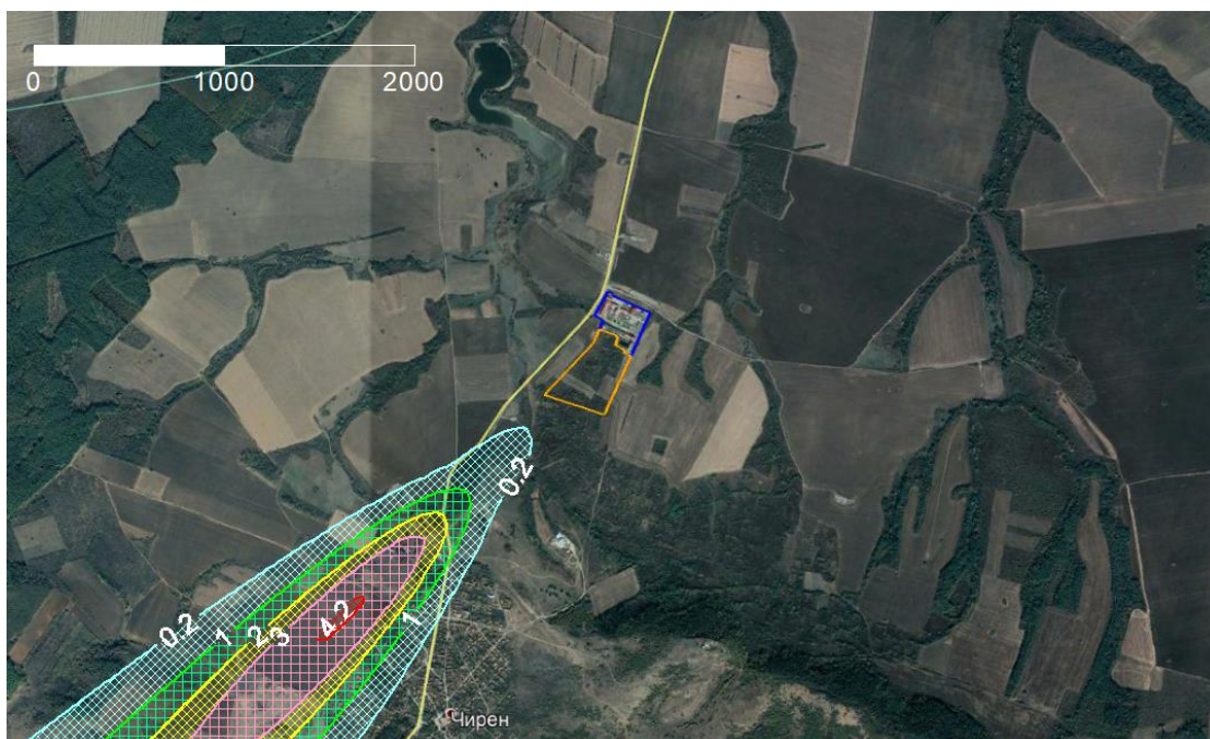
Фигура 37 Еднократно поле на замърсяване с азотни оксиди (NO x ) от работа на ГТКА в режим на нагнетяване
