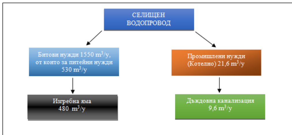
Фигура 5 Балансова схема на водите в Дружеството
