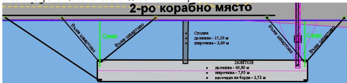
Фигура 10. Схема в план на поставяне на понтона
