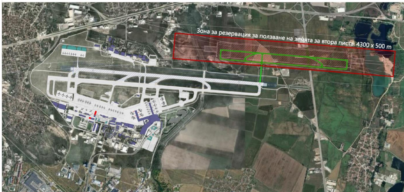
Фигура 7: Ориентировъчно местоположение и изглед на втори вариант за изграждане на втора паралелна писта
