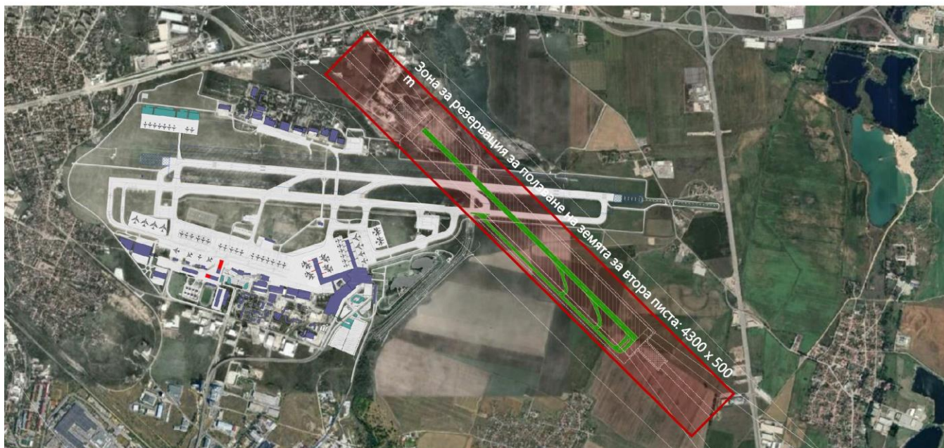
Фигура 6: Ориентировъчно местоположение и изглед на първи вариант за изграждане на втора писта, пресичаща съществуващата такава
