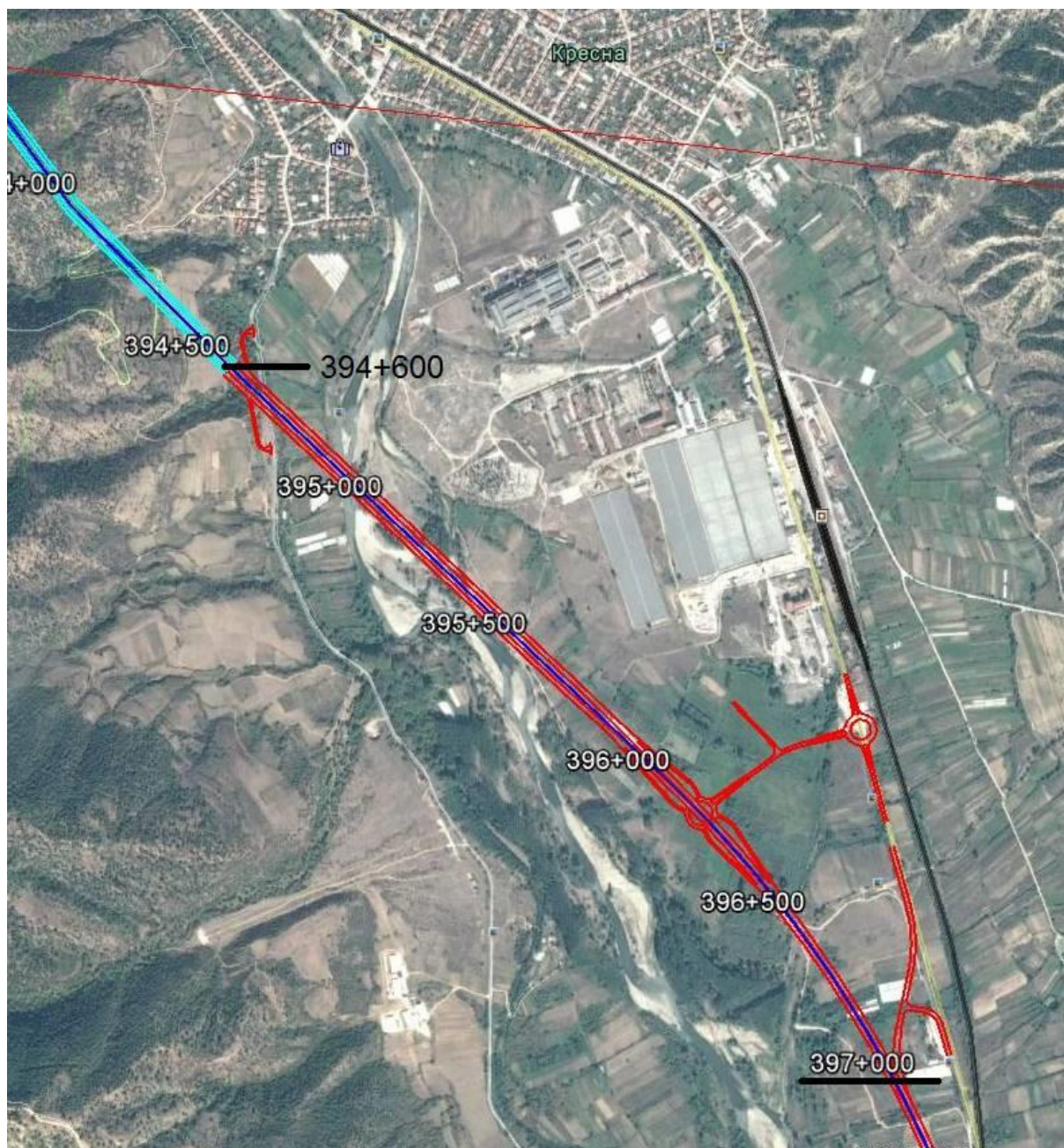
Фигура № II.1-7. Ситуация на пътна част, км 394+605 южен портал, дясно платно на тунел Кресна, км 394+600 южен портал ляво платно на тунел Кресна, край на трасето км 397+000, където се включва в Лот 3.3
