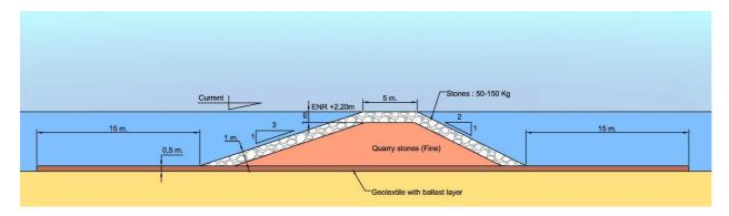
Figure II-12: Schematisation of a groin
