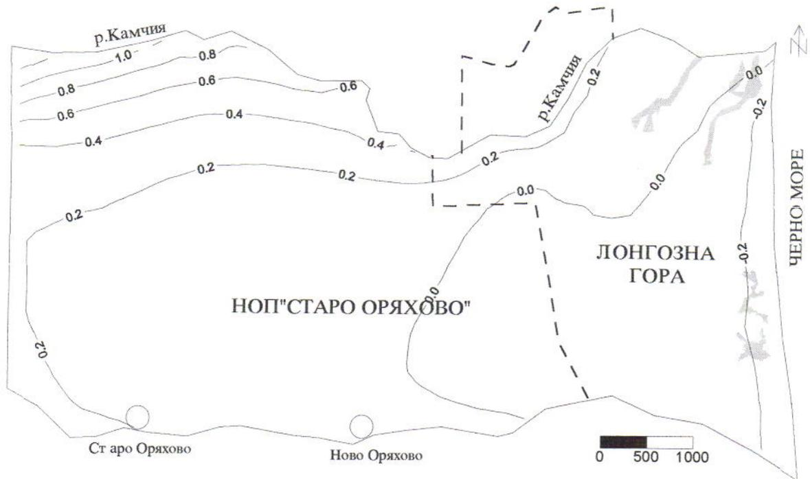
Фиг.5-4. Първи прогнозен модел. Структура на подземния поток 30 дни след изключване на дренажната система
