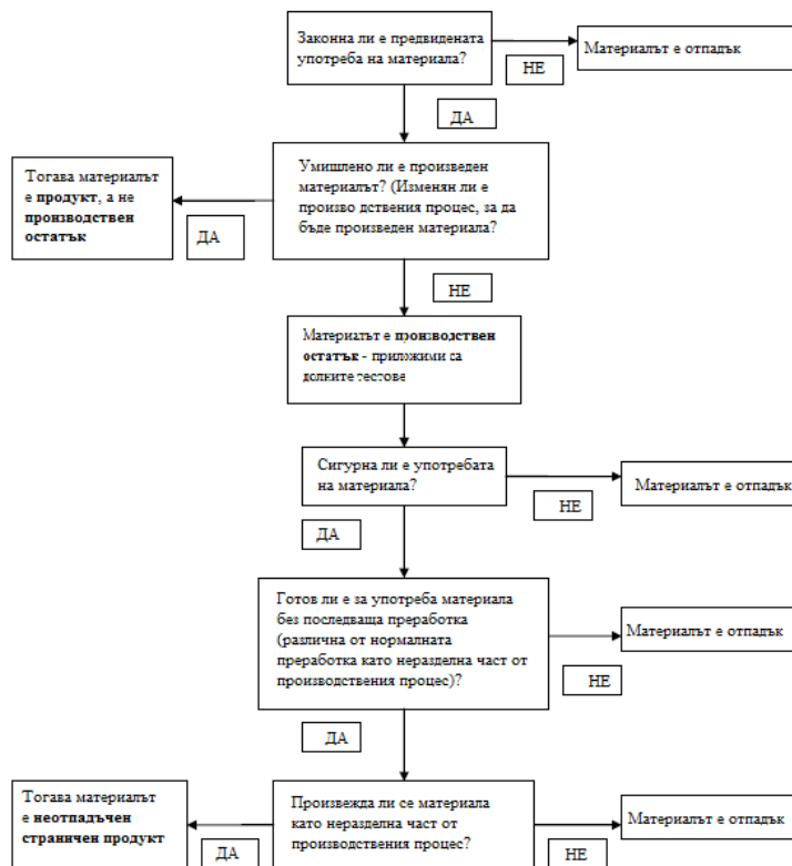
Фигура 1: Схема при взимане на решение дали един материал е страничен продукт 19
