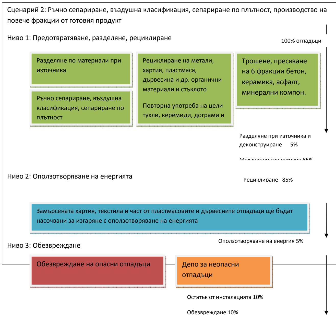
Фигура № 7 Схема на Сценарий 3: Ръчно сепариране, въздушна класификация, сепариране по плътност, производство на повече фракции от готовия продукт
