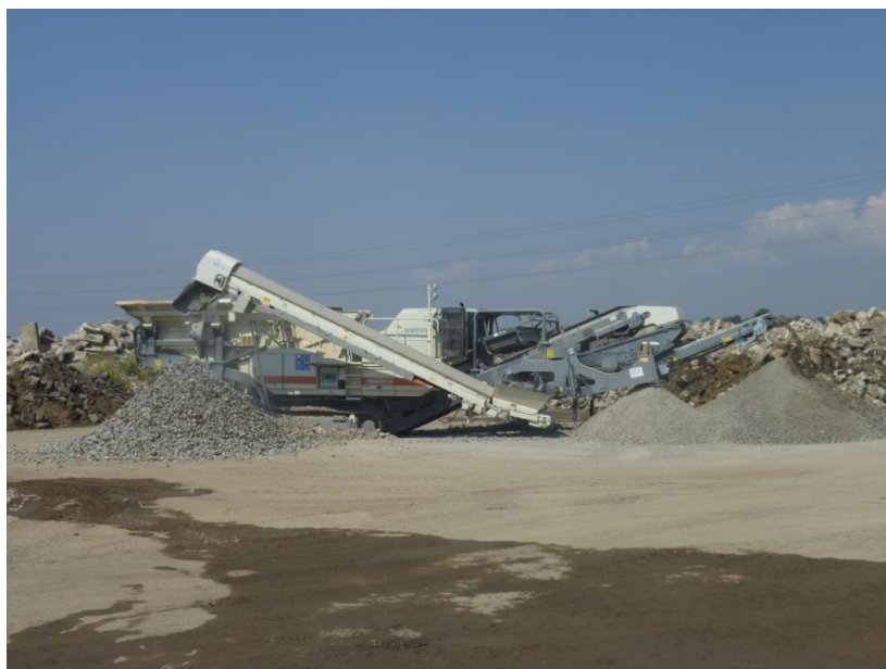
Фиг.3. Полустационарна инсталация за рециклиране на СО край гр. София.
