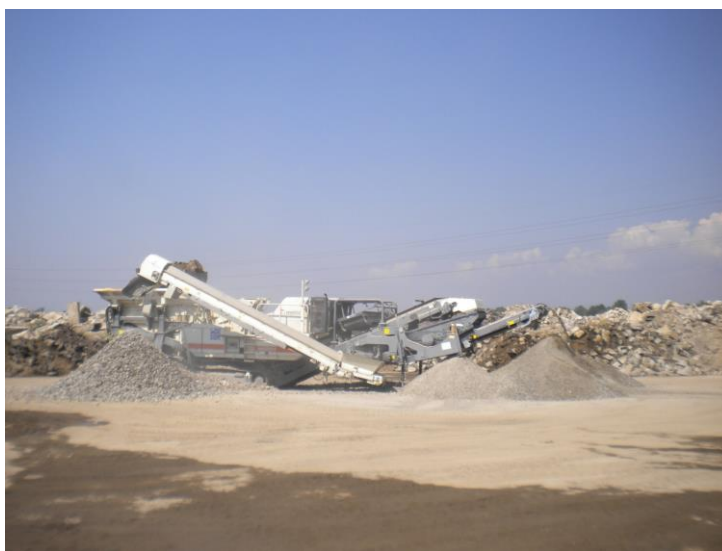
Фиг. 9. Рециклиране на стоманобетонни СО и различни фракции продукти от оползотворяване на СО
