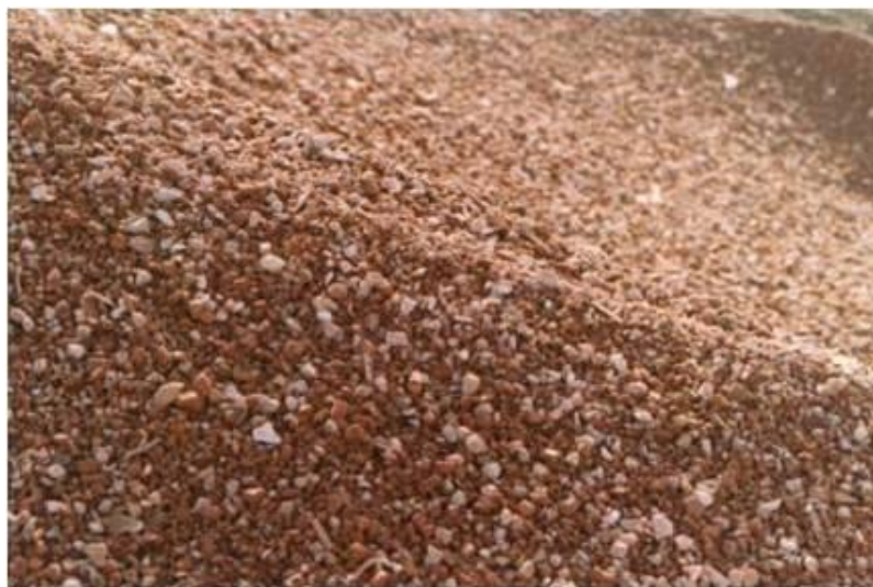
Фиг.11. Трошен камък от рециклирана строителна керамика
