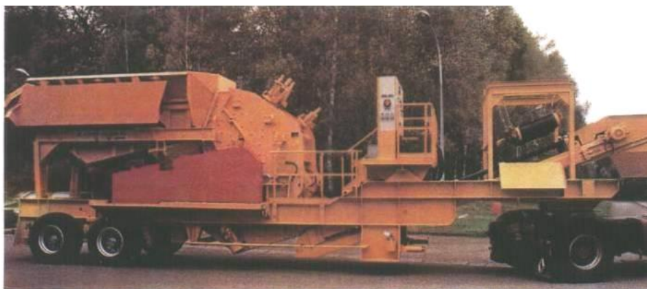
Фиг.4. Мобилна инсталация за рециклиране.
